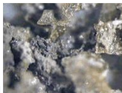
Materiał uzyskany po mikrofalowej obróbce termicznej
